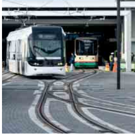
富山駅 edilon)(sedra ERS 埋め込みレール システム
